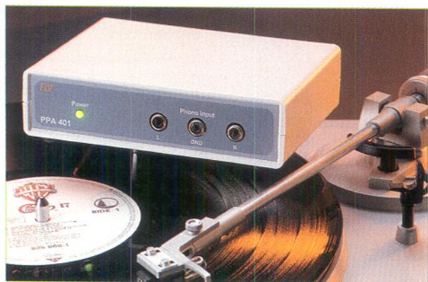
Bild 1: Für Plattenspieler mit einem Magnet-Abtastsystem wird ein solcher Phono-Entzerrer benötigt.
