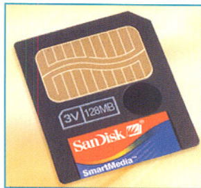
Bild 5: Superflach und ohne eigene Intelligenz – die Smart Media Card. Bild: SanDisk
