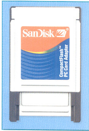
Bild 3: Über solch einen Adapter kann man CF-Karten im PCMCIA-Schacht des Laptops betreiben. Bild: SanDisk
